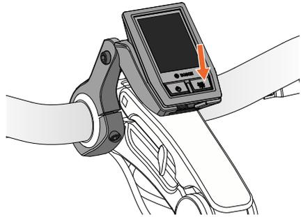
Abbildung 1 - Einschalten der Fahrradbeleuchtung.
