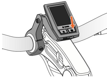
*Figuur 1 - Aanzetten fietsverlichting.*
