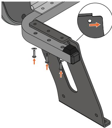
Abbildung 2 - Einsetzen des Fußes am Untergestell der Sitzbank.
