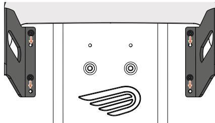
Figuur 4 - Plaatsen en bevestigen voorbank.
