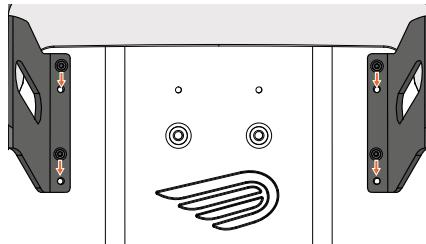
Figure 4 - Placement et fixation du siège avant.
