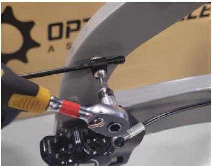
*Figure 5 - Retrait des tiges du garde-boue.*
