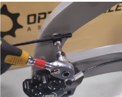
*Abbildung 5 - Abnehmen der Kotflügelstangen.*
