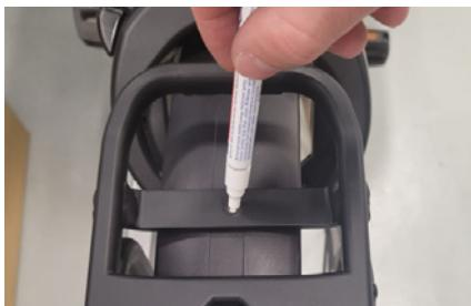
*Abbildung 7 - Markierung des Bohrlochs auf dem Radspitzschutz.*
