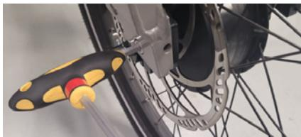
Figure 2 - Dévissage des pattes de fixation.
