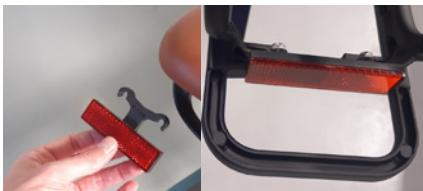
Figure 1 - Montage du réflecteur sur le porte-bagages.
