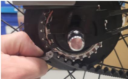
Afbeelding 4 - Versnellingkabels verwijderen.
