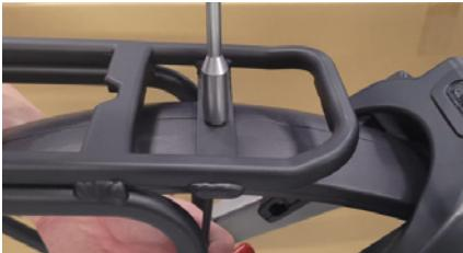
Figure 9 - Fixation du porte-bagages au garde-boue.
