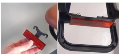
Abbildung 1 - Montage des Reflektors am Gepäckträger.
