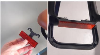
Afbeelding 1 - Monteren reflector op achterzijde bagagedrager.
