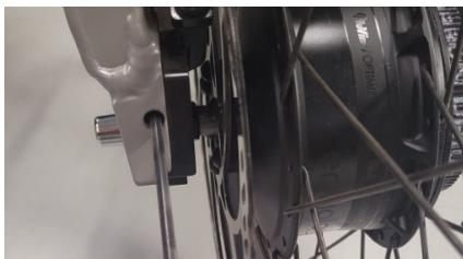
Figure 12 - Tension de la courroie.
