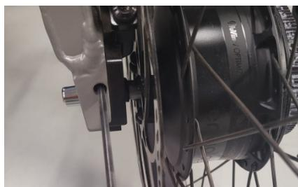
Abbildung 3- Entfernen Sie die Spannung des Riemens.
