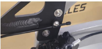
Afbeelding 10 - Vastzetten bouten bagagedrager en spatbordstangen.
