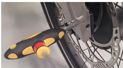
Abbildung 13 - Sicherung der Ausfallenden.
