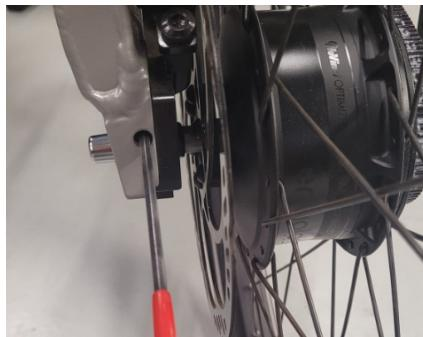
Afbeelding 3 - Verwijderen spanning op belt.
