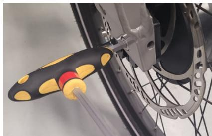
Afbeelding 13 - Vastzetten dropouts.
