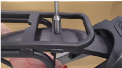
Abbildung 9 - Befestigung des Gepäckträgers am Kotflügel.
