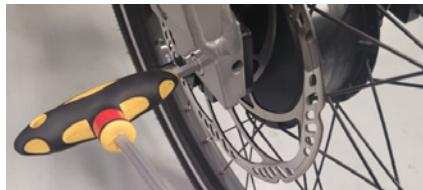
Afbeelding 2 - Losdraaien dropout.
