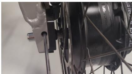
Abbildung 12 - Spannen des Riemens.
