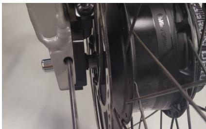
Figure 3 - Retirez la tension de la courroie.
