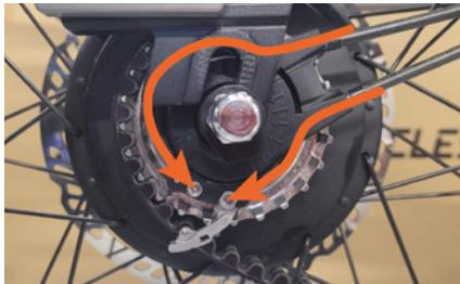
Figure 11 - Remplacez les câbles de changement de vitesse.
