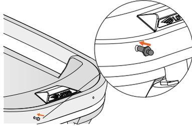
Figuur 5 - Bevestigen van de schroef met drukverbinding.
