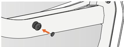
Abbildung 8 - Schließen der Schlaufenverbindungen.
