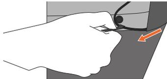
Figure 13 - Fixation de la boucle autour du bouton pression pour boucle.
