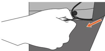
Abbildung 13 - Anbringen der Schlaufe an den Schlaufenverbindungen.
