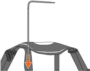
Abbildung 3 - Einsetzen der Stangenkombinationen in die Regenhaube.
