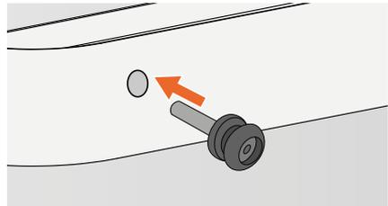
Abbildung 7 - Befestigen der Schraube mit Schlaufenverbindung.
