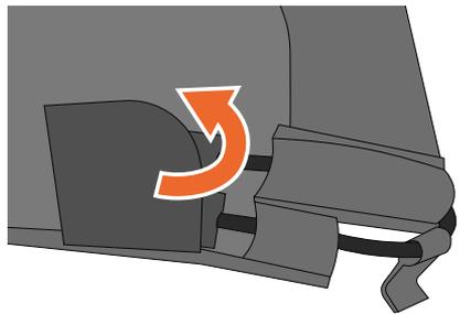
Abbildung 16 - Ersetzen Gummibänder.
