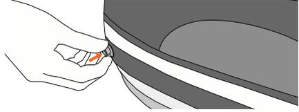
Figure 11 - Fixation des boutons pression à l'avant
