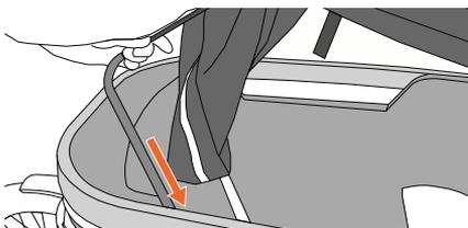
Figuur 10 - Bevestigen van de stokken.
