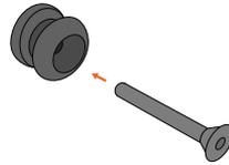
Abbildung 6 - Einsetzen der Flachkopfschraube in die Schlaufenverbindung.
