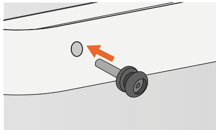
Figuur 7 - Bevestigen van de schroef met lusverbinding.
