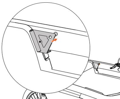
Figure 4 - Fixation des attaches au cadre.
