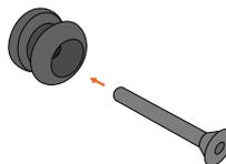
Figure 6 - Insertion de la vis à tête plate dans le bouton pression pour boucle.
