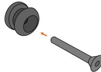
Figuur 6 - platkop schroef in lusknop plaatsen.
