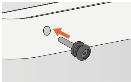
Figure 7 - Fixation de la vis avec bouton pression pour boucle.
