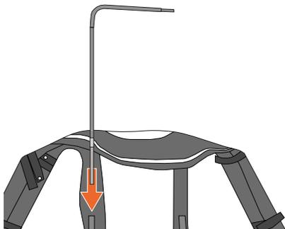
Figure 3 - Placement des tiges assemblées dans la tente de pluie.
