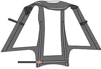
Abbildung 2 - Einsetzen der Mittelstange in die Regenhaube.
