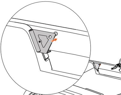
Figuur 4 - Bevestigen van de opzetstukken aan het frame.
