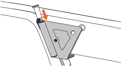
Figure 9 - Ouverture des bouchons des attaches.
