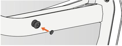
Figure 8 - Finition des boutons pression pour boucle.
