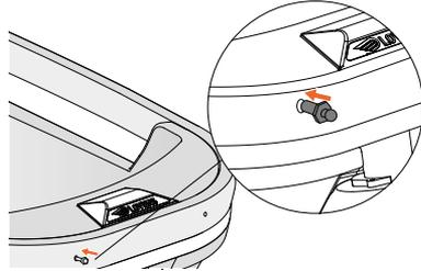
Abbildung 5 - Befestigen des Bolzens mit Druckanschluss.
