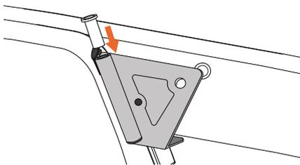
Abbildung 9 - Öffnen der Kappen für Nylonhülsen.
