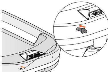
Figure 5 - Fixation de la vis avec bouton pression.
